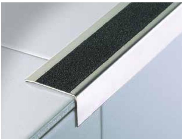
STAIRTEC SI est un nez de marche qui combine les caractéristiques de résistance mécanique et chimique de l'acier inox à la sûreté donnée par la bande antidérapante noire, à appliquer après le montage et à commander séparément. Fixé sur des revêtements déjà posés, le nez de marche est recommandé pour des installations dans les endroits industriels et commerciaux. Prescrit pour les rénovations et la mise aux normes des lieux publics. Le profil peut être fixé au support avec vis ou adhésif.
